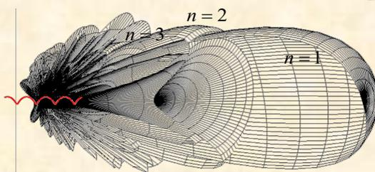
ILアンジュレータシンクロトロン放射場
