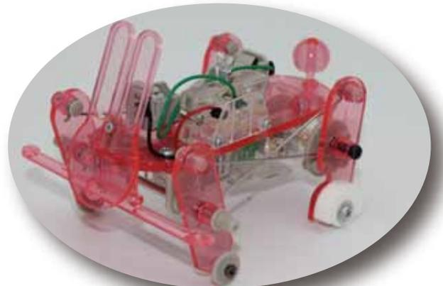
ニッパー・プラスドライバーなどを使ってロボットを作製しながら動く仕組みを学びます
