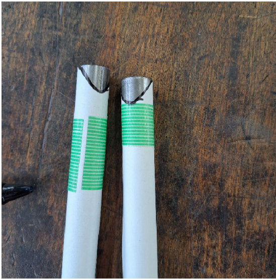
紙を巻き付けた状態のパイプ
