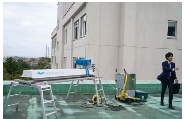
教育・研究3号館(N棟)屋上に設置された研究設備(GB-SAR)
