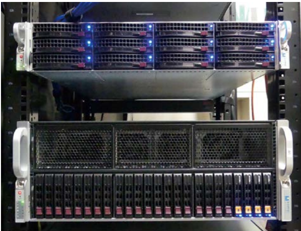
写真3 AI開発システム (上：ディスクサーバ、下：GPUサーバ)
