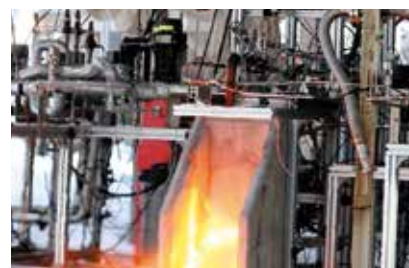
▲ガスジェネレータ60秒スロットリング試験
