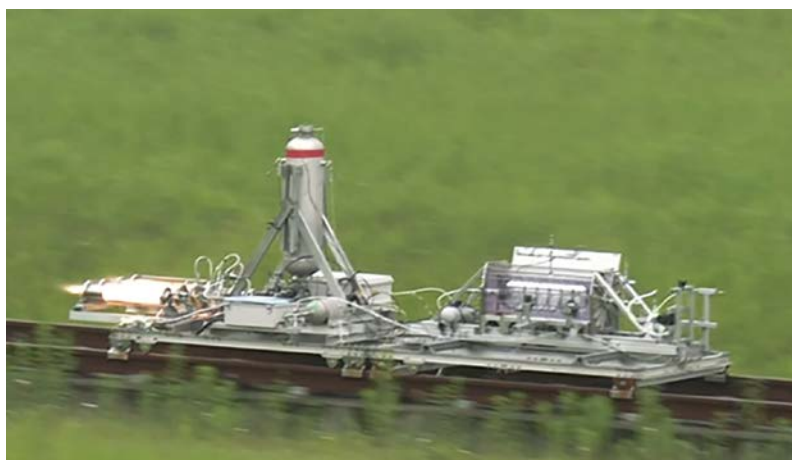
Run55では本学今井研究室のスロッシング防止デバイスを備えた透明タンクにステップ状加速度を与え、流体挙動を観察した。
