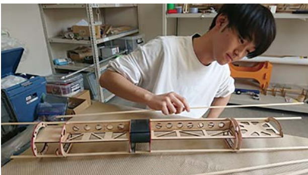
胴体内部構造の組み立て
