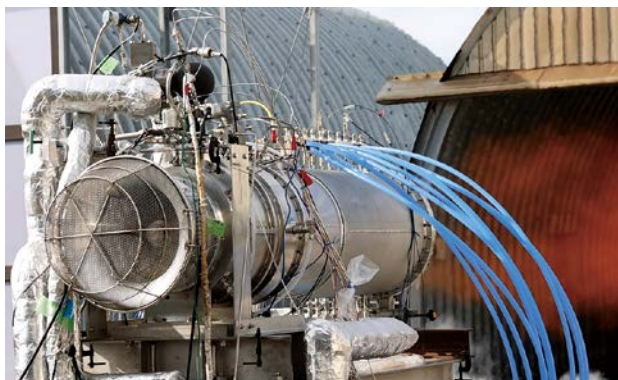
エアターボラムジェット（ATR）エンジン燃焼試験の様子
