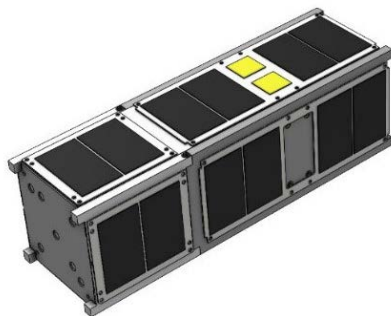
図1 超小型人工衛星「HOKUSHIN-1」 太陽電池パネル 展開前
