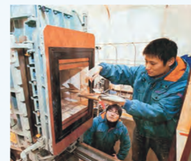
図2 マッハ数2の超音速風洞試験
