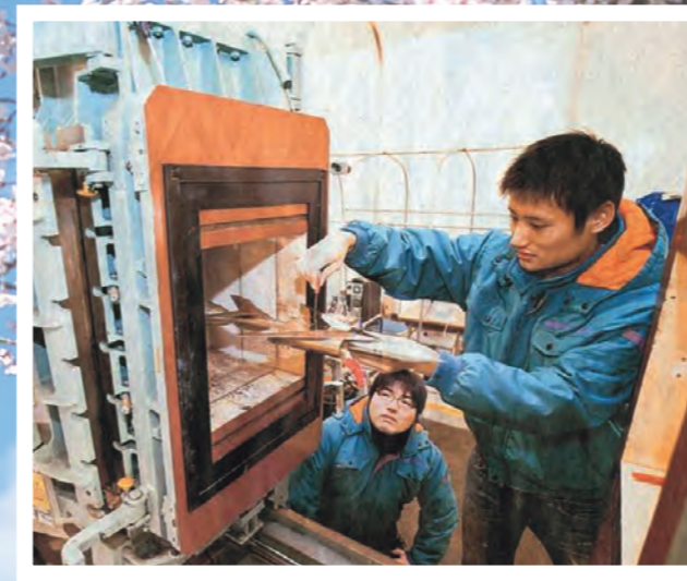
←マッハ数2の超音速風洞試験 (航空宇宙機システム研究センター)
