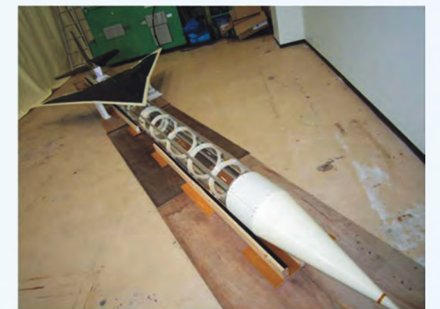
図3 オオワシ2号機のモックアップ模型
