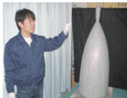
図1：NITE法(私たちの特許)によるSiC/SiC複合材料性ロケット・スラスタの製造
