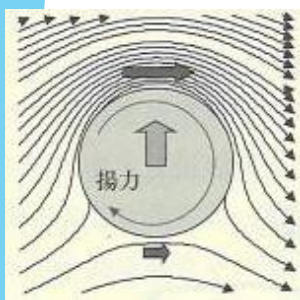
図1 回転円筒によって発生する揚力
